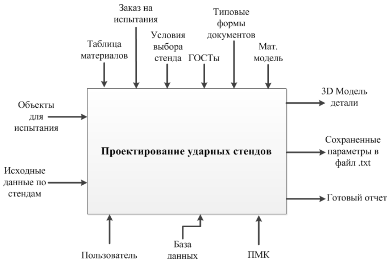
Рис. 1. Контекстная структурно-функциональная модель нулевого уровня процесса «Проектирование ударных стендов»
